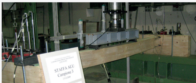
Prove su campioni di dimensioni reali (connessione trave principale - trave secondaria)
