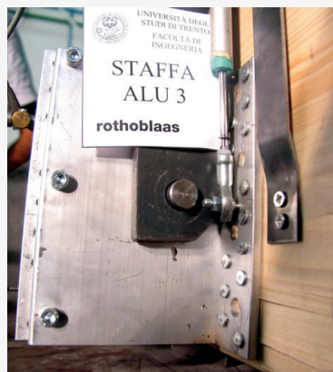
Prove su campioni di dimensioni ridotte (legno-legno e legno-calcestruzzo)
